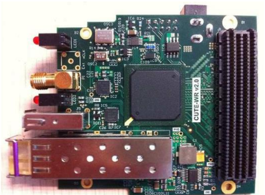
图 7 FMC 子卡形式的 WR 节点
